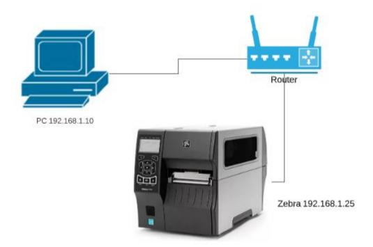
Se cuenta con una computadora conectada al router (IP 192.168.1.25). En la misma se encuentra instalado el Driver de Zebra que tiene configurado el Puerto de conexión como 192.168.1.25 (dirección IP de la impresora Zebra)
