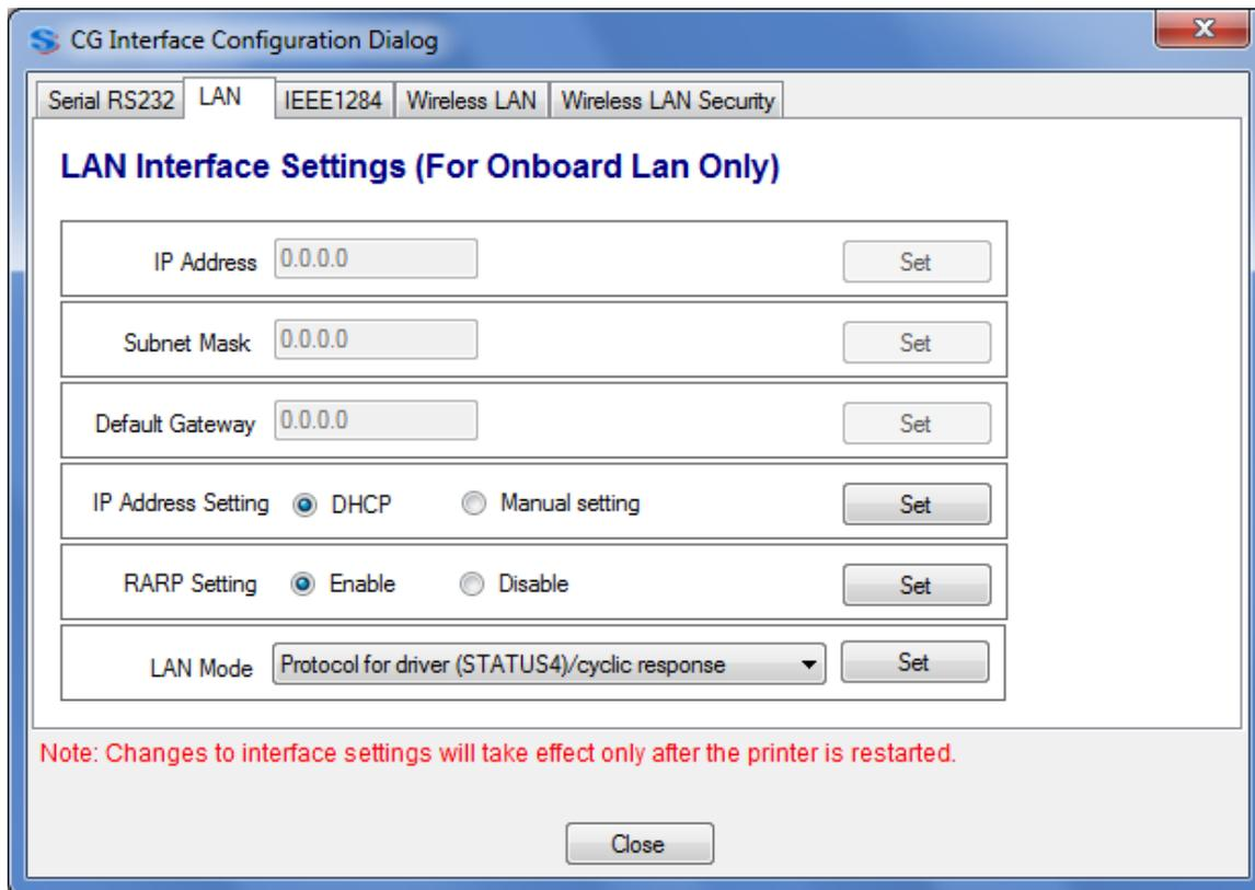
En IP Address Setting seleccionamos Manual Setting y presionamos sobre el botón Set.
