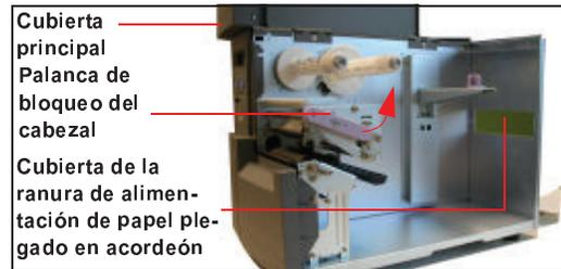
2. Apile el papel plegado en acordeón por detrás de la impresora e introdúzcalo por la ranura de alimentación de papel plegado en acordeón, por encima del soporte de etiquetas. Empuje el tope púrpura de etiquetas para que presione las etiquetas ligeramente contra el lado de la impresora.
