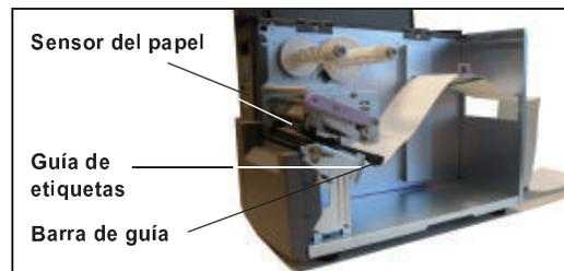
4. Utilice la placa metálica de la guía de etiquetas para presionarla contra el papel para que éste salga en ángulo recto desde el cabezal de impresión.
