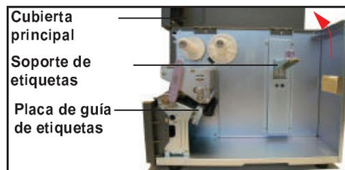
2. Cargue los rollos de cinta tal como se ha descrito con anterioridad. Tire de la placa de guía de etiquetas hacia abajo. A continuación, inserte un rollo de etiquetas en el soporte de etiquetas. Empuje el tope púrpura de etiquetas contra el rollo de etiquetas para evitar que se deslice hacia los lados.
