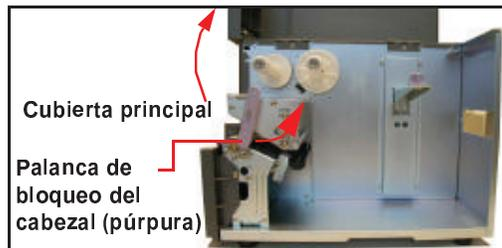
2. Tire hacia arriba de la palanca púrpura de bloqueo del cabezal en sentido contrario a las agujas del reloj. El conjunto del cabezal de impresión se levantará para que pueda cargar la cinta. El eje de plástico blanco situado más a la derecha es el eje de alimentación de la cinta. El situado más a la izquierda es el eje rebobinador de cintas.
