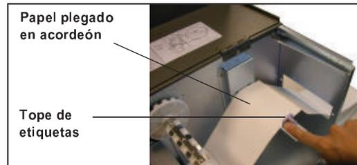
3. Guíe las etiquetas por debajo del sensor del papel y el cabezal de impresión y sáquelas por la parte frontal de la impresora. Asegúrese de que las etiquetas pasan por debajo de la barra de guía de plástico negra situada junto a la guía de etiquetas.
