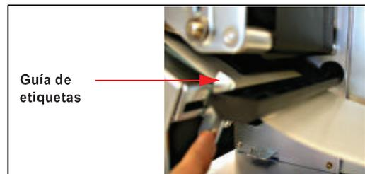
5. Cargue las etiquetas y la cinta, gire la palanca púrpura de bloqueo del cabezal en el sentido de las agujas del reloj para volver a bloquear el conjunto del cabezal de impresión en su sitio y realice una prueba de impresión para comprobar si las etiquetas y la cinta están correctamente cargadas.
