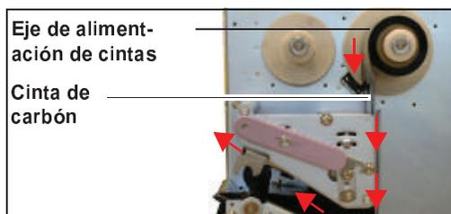
4. Inserte un mandril de cinta vacío en el eje rebobinador de cintas. En caso necesario, fíjela con cinta adhesiva y enróllela un par de veces en torno al mandril.
