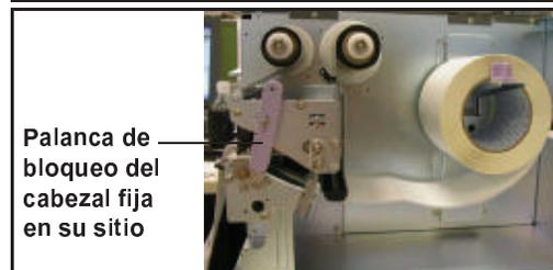
4. Asegure la palanca de bloqueo del cabezal empujándola en el sentido de las agujas del reloj hasta que el cabezal de impresión quede bloqueado en su sitio. Levante la placa de guía de etiquetas y empújela contra el lado exterior de las etiquetas para limitar y enderezar el recorrido. A continuación, gire la palanca púrpura de bloqueo del cabezal en el sentido de las agujas del reloj para volver a bloquear el conjunto del cabezal de impresión en su sitio.
