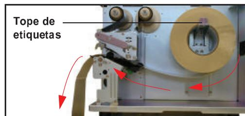
3. Guíe las etiquetas por debajo de la cinta, asegurándose de que se introducen entre los sensores de papel. Las etiquetas deberían salir en ángulo recto desde el cabezal de impresión.
