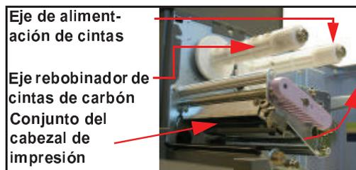
3. Inserte la cinta de carbón en el eje de alimentación de la cinta. Empuje el rollo de cinta hacia el interior, hasta el final, de modo que la cinta se enrolle en sentido contrario a las agujas del reloj, como muestra la imagen. Enrolle la cinta alrededor del conjunto del cabezal de impresión hasta que llegue al eje rebobinador de cintas. El lado mate de la cinta debe ir hacia abajo.
