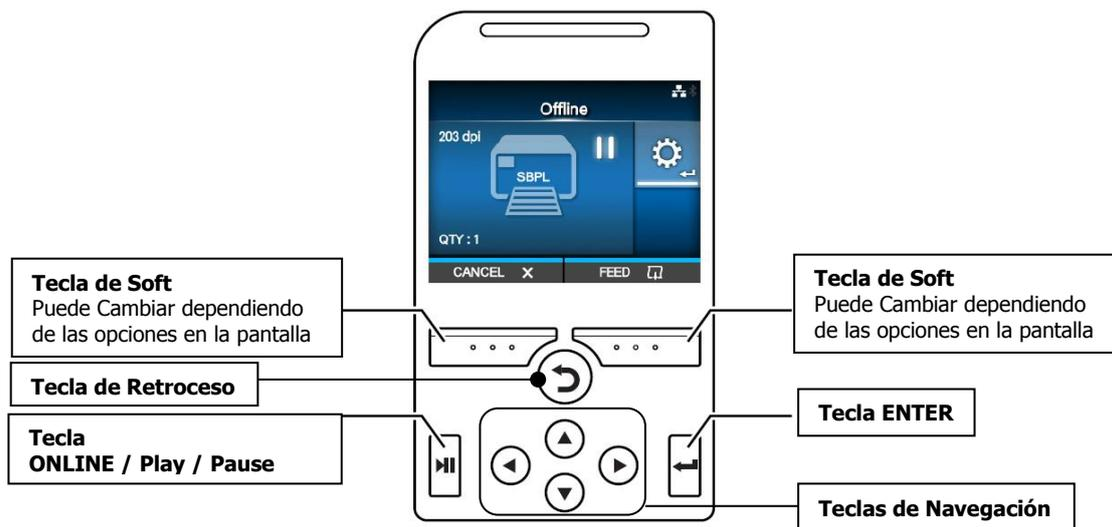
3. Una vez dentro, con las teclas de Navegación nos desplazamos hasta el ícono de "Applications"
