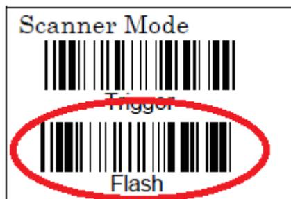
En este modo de operación, el Lector leerá los códigos automáticamente. Luego de unos segundos si no está operando comenzará a parpadear el laser y se tornará fijo al acercarlo a un código nuevamente. Para volver al modo de fábrica, sólo basta con leer el código Trigger.
