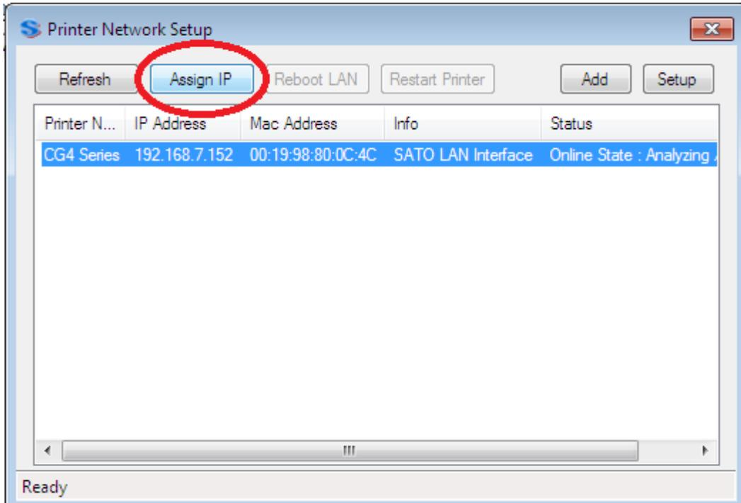
Se nos abrirá una ventana para la configuración de la IP, deberemos desactivar el checkbox de DHCP y de RARP, y completaremos los valores a nuestra preferencia.
