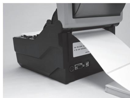
3. Sujetando a la vez la **palanca de deslizamiento de la guía de las etiquetas**, ajuste el ancho del **soporte del papel** ① para adaptarlo al tamaño del papel. Tire del extremo de las etiquetas, páselo por las **guías de etiquetas** y coloque el borde anterior de las etiquetas encima del **rodillo de tracción papel**.
