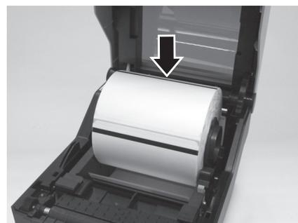
4. Tire del extremo de las etiquetas, páselo por las **guías de etiquetas** y coloque el borde anterior de las etiquetas encima del **rodillo de tracción papel**.
